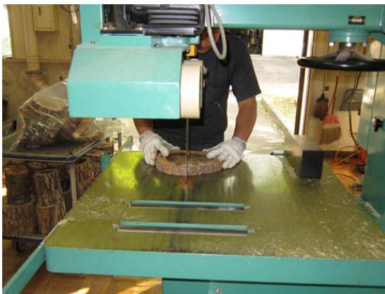
写真 7.2.4 含水率試験片作成の様子
