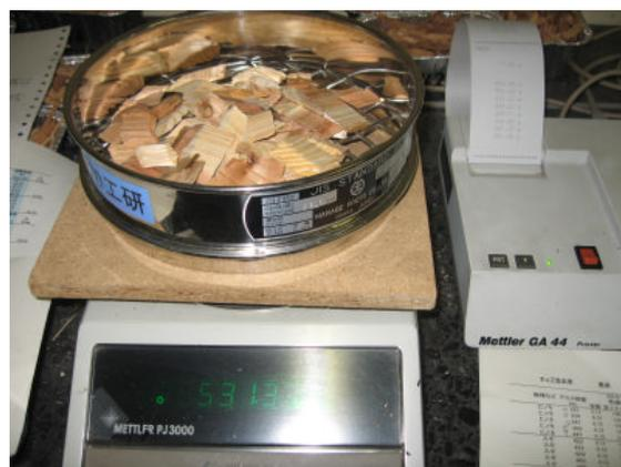
写真 8.3.4 振とう後ふるい重量の測定
