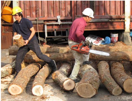
写真 7.2.2 含水率、密度測定用円盤の採取
