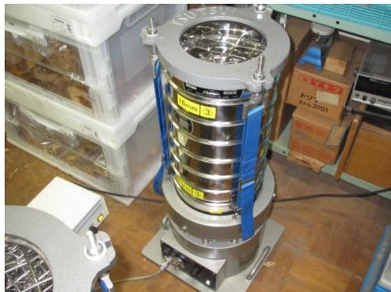
写真 8.3.2 電磁式ふるい振とう機
