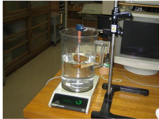
写真 7.2.6 生材体積測定システム
