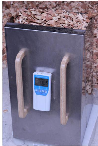
写真 4.4 静電容量式チップ用含水率計
