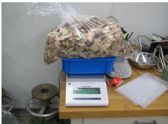
写真 5.3.1 チップの重量測定
