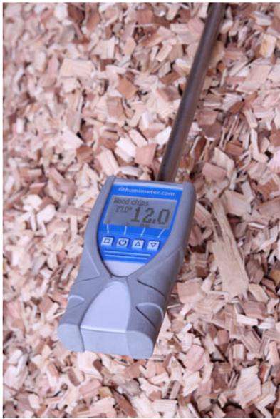
写真 4.3 電気抵抗式チップ用含水率計
