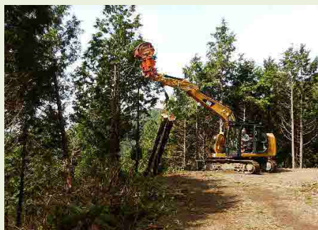
スイングヤーダによる集材（間伐）
