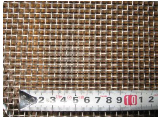
写真 4.2.2 ふるいの網目(目開き 4mm)
