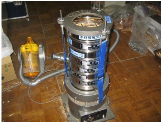
写真 4.3.1 電磁式ふるい振とう機
