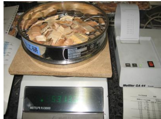
写真 4.3.2 振とう後ふるい重量の測定
