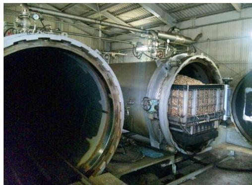
写真 2.9 圧力煮沸装置による熱処理
